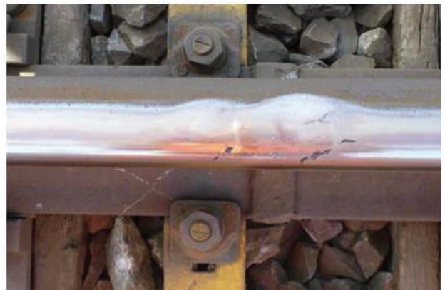
Slika 6. Prslina u squat defektu i lokalno udubljenje kod aluminotermijskog zavora
