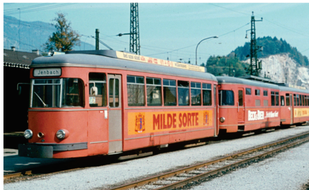
Slika 1. Prvi električni voz u Cilertalu, pokretan dizel generatorskim vagonom 1967 © 1980 wikipedi-ja, prvobitno je saobraćao u Ravensburgu. Nakon obustave rada tamo, došao je u RTM (Roterdamski tramvajski voz Maatšapij), gde je dodat srednji dizel generatorski vagon da bi radio bez kontaktne mreže. Širina koloseka je promenjena sa 1000 mm na 1067 mm.
