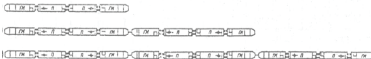
Slika 4 - Broj osnovnih sastava u kompoziciji elektromotornog voza [10]
