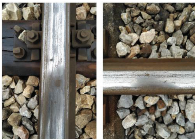
Slika 5. Primer kombinovanog defekta koji uključuje corrugation, squat i squat seed
