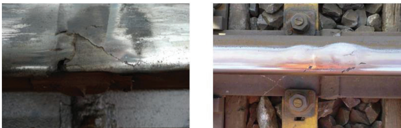
Slika 6. Prslina u squat defektu i lokalno udubljenje kod aluminotermijskog zavora
